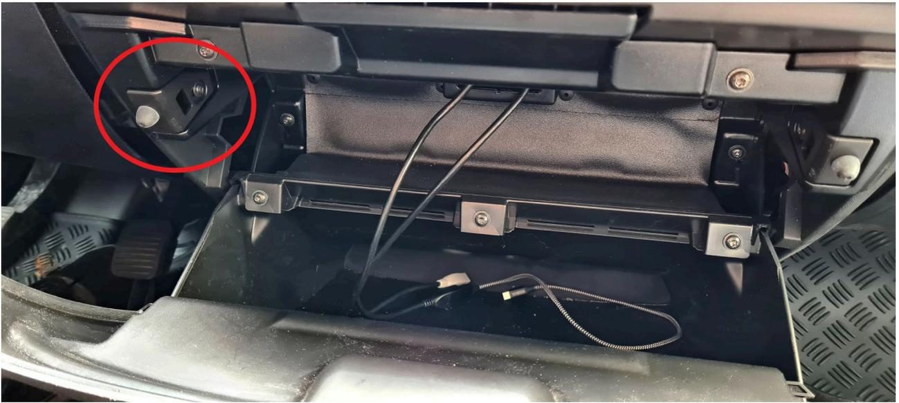
Mit einem Torx Schraubenzieher löst man die Schraube, verschiebt das Schließblech nach vorne und schraubt es wieder fest. Nun ist bei der Klappe mehr Spiel, der Becherhalter kann eingehängt werden und die Klappe schließt wieder.
