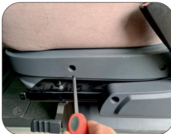
2. Mit Kreuzschraubendreher die Originalschraube herausdrehen und entnehmen. Sie wird nicht mehr benötigt.
